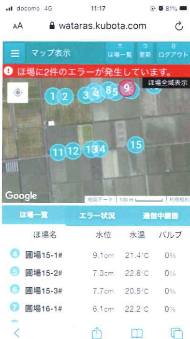
図 12 情報端末により水深の監視や給水・止水の制御が可能
