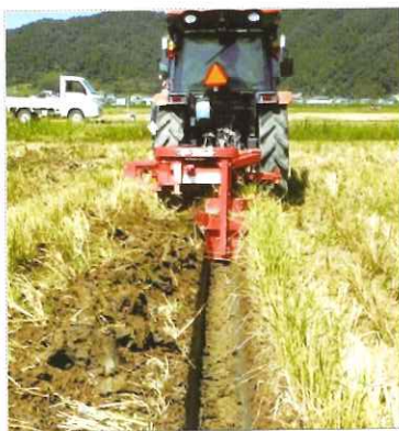
図 22 直進アシスト走行による明渠施工（左）は慣行（右）に比べて直進精度が高い
