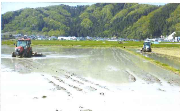
図5 自動走行機＋有人機の協調運転による代かき作業
