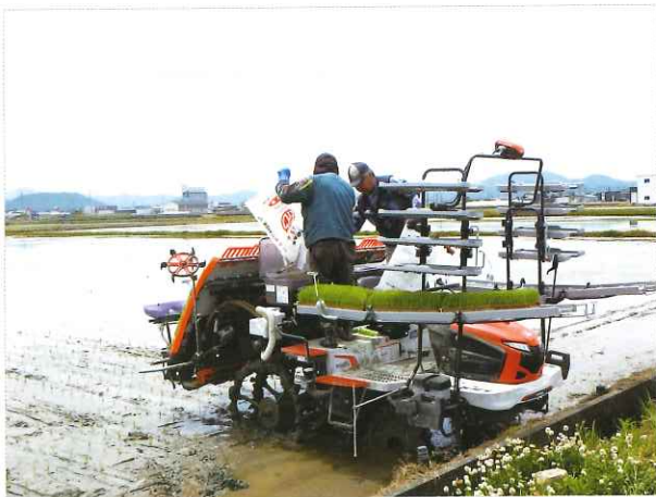
図8 直進アシスト田植機による移植作業
